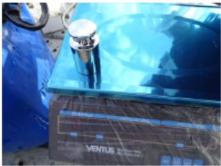
Verificación en terreno de balanza de medición con masa patrón de 500 gr.
